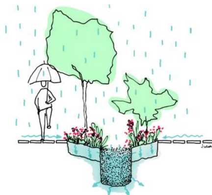
Figura 35: Esquema de áreas de biorretención o bioswales para el mejoramiento de la calidad del agua antes de evacuarlas en el estero Las Toscas. Fuente: Guía Técnica para el diseño de SUDS en el AMSS (Consejo de Alcaldes del Área Metropolitana de San Salvador, 2021).
